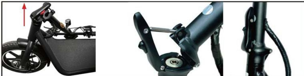
1. Izvadite sklopivi električni skuter iz kutije i povucite ručicu za zaključavanje stupa upravljača prema naprijed i nagnite upravljač prema gore. Zatim ponovno gurnite ručicu za zaključavanje unatrag.
