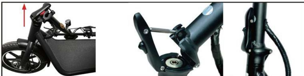
1. Saque el scooter eléctrico plegable de la caja y tire de la palanca de bloqueo de la columna del manillar hacia adelante e incline el manillar hacia arriba. A continuación, vuelva a deslizar la palanca de bloqueo hacia atrás.
