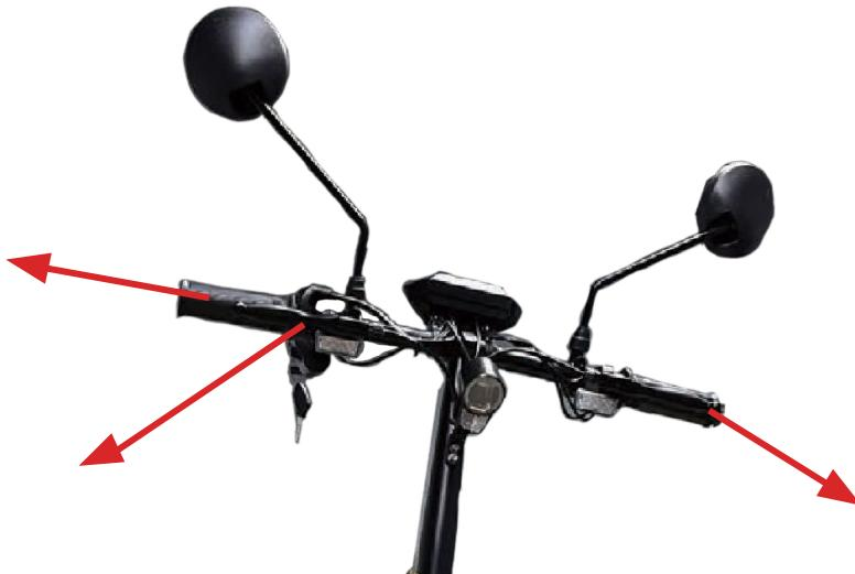
Usa la manopola dell'acceleratore per accelerare. Per frenare è possibile utilizzare i freni anteriore e posteriore. Puoi scegliere tra tre livelli di velocità.
