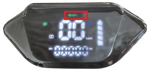
Inserte la llave en el interruptor de encendido bloqueado en el manillar derecho, gírelo en el sentido de las agujas del reloj, la pantalla y la luz delantera se encenderán para indicar que se ha conectado la alimentación. Gire la llave en sentido contrario a las agujas del reloj para apagar la alimentación, la pantalla y la luz delantera.
