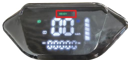
Umetnите ključ u prekidač za napajanje zaključan na desnom upravljaču, okrenite ga u smjeru kazaljke na satu, uključit će se zaslon i prednje svjetlo kako bi naznačili da je napajanje priključeno.
