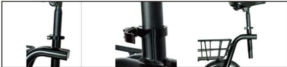
3. Odprite hitro sprostitev na sedežu na okvirju in vstavite sedež. Nastavite višino sedeža v udoben položaj, nato zaprite hitro sprostitev.
