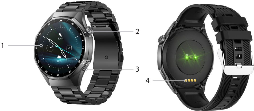
1. Pantalla táctil; 2. Corona digital; 3. Botón funcional; 4. Conector de carga
